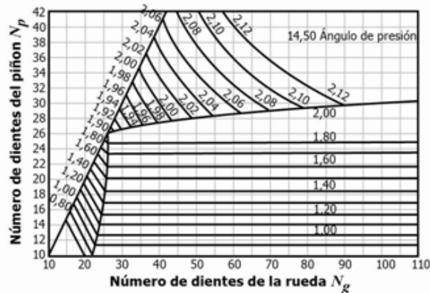
Figura 1 1 Razón de contacto ( m_c ) en función de los números de diente de piñón y engranaje
