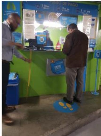
5. **No conformidad 5:** No se evidencia en el ingreso a la torre 2, señales para usuarios con movilidad reducida o discapacidad auditiva o visual; según lo indicado en la norma NTC 6047 en el numeral 7.2.2 “Señalización para ubicación, senderos guiados y demás información de soporte físico”
